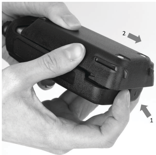
Рис. 3. Снятие аккумуляторной батареи.
