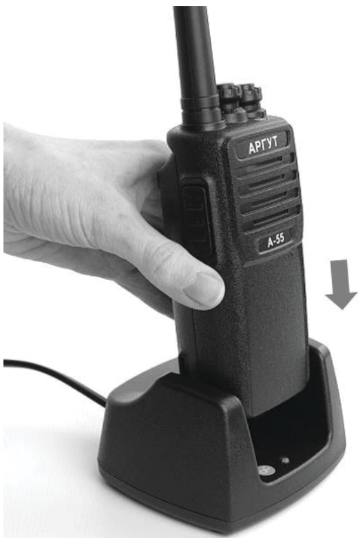
Рис. 6. Установка радиостанции на зарядку.
