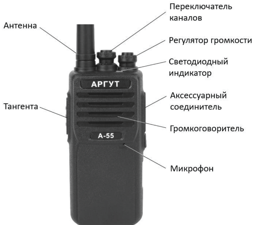
Рис. 1. Расположение органов управления, индикации и соединителей.
