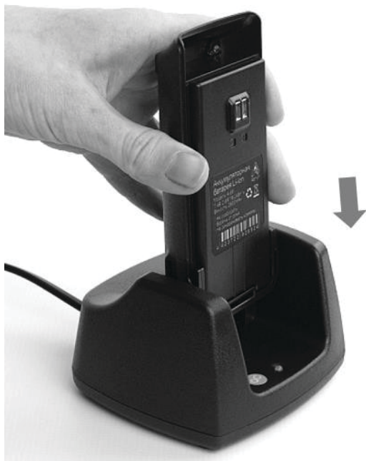
Рис. 7. Установка аккумуляторной батареи на зарядку.
