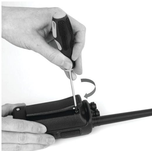
Рис. 5. Присоединение клипсы для крепления.
